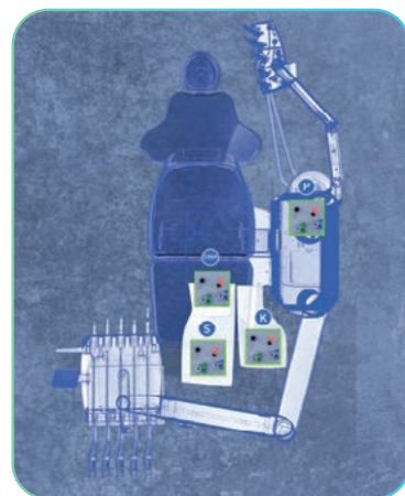
možna montaža stola brez spreminjanja obstoječih talnih instalacij, ki so bile prilagojene nekaterim drugim proizvajalcem zobozdravniških stolov
